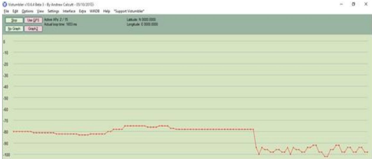
Fig. 4.6 Medición de indicador de fuerza de la señal recibida (señal deficiente).
