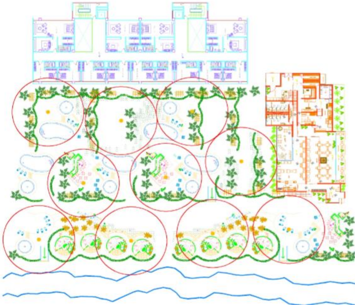
Fig. 4.12 Propuesta de equipos AP para servicio de Internet móvil en albercas y zona de playa.
