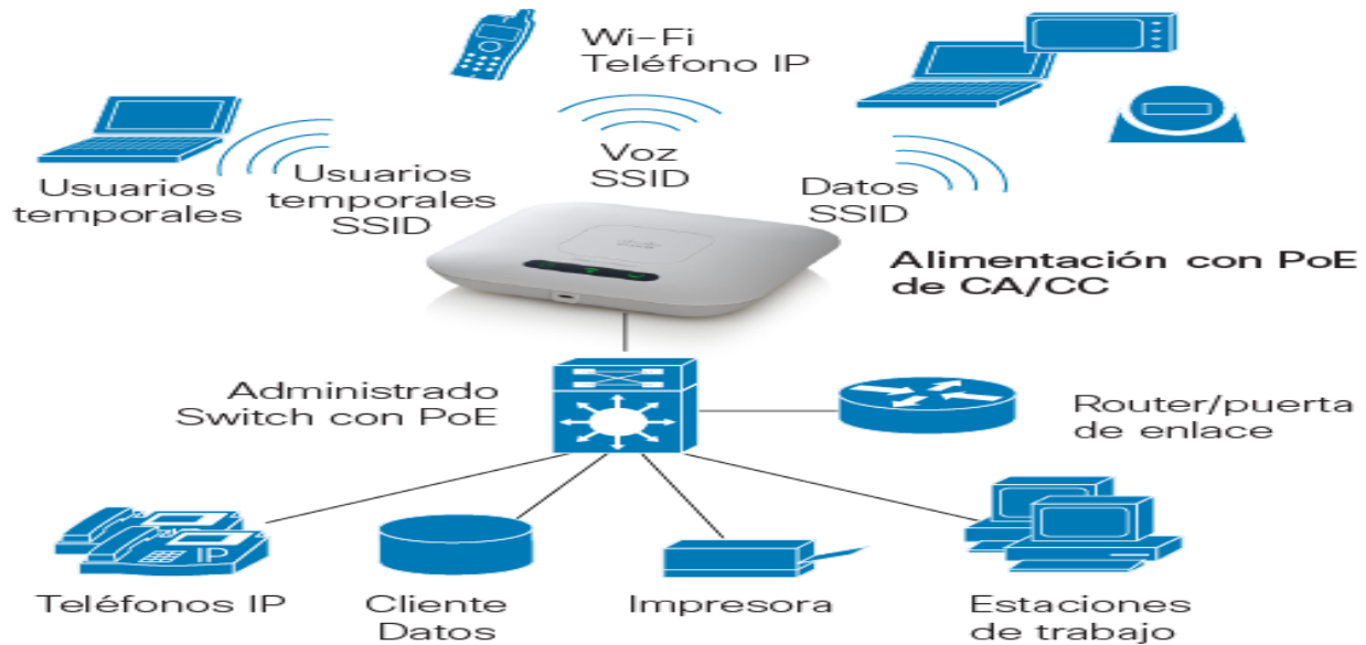
Fig. 3.6 Alimentación de Access Point mediante PoE.
