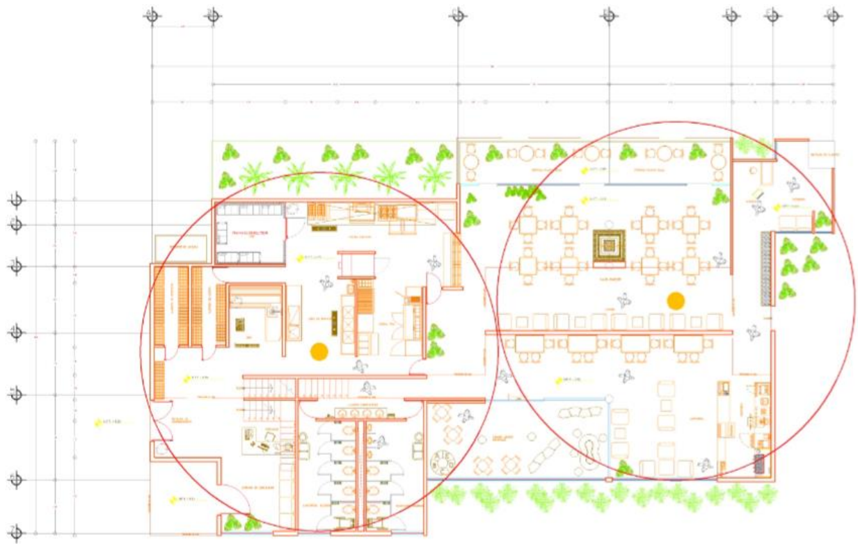
Fig. 4.10 Propuesta de equipos para servicio de Internet móvil en restaurante.
