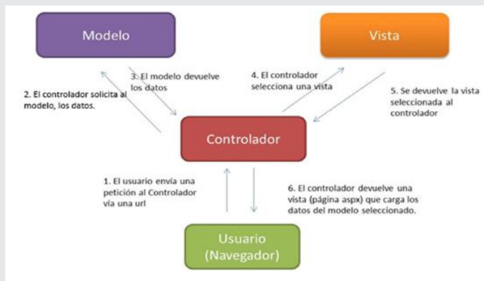
Figura 2. Flujo de control del Modelo Vista Controlador (MVC). [4]
