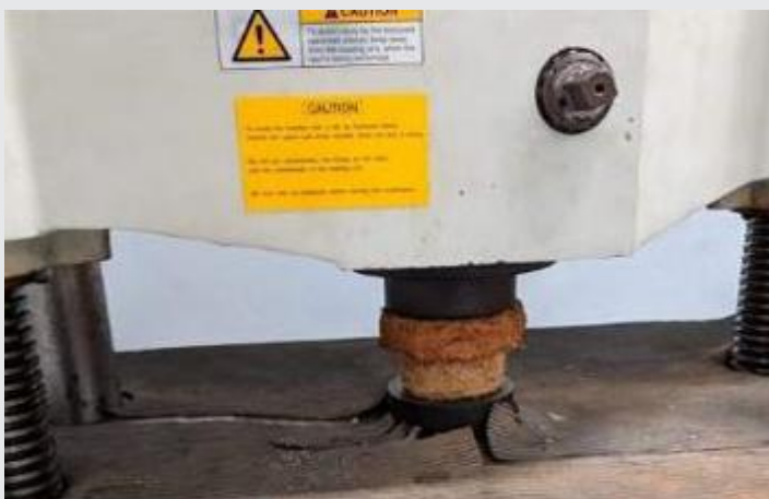
Figura 6. Prueba de resistencia. La imagen muestra la prueba de resistencia aplicada a un prototipo de la urna.
