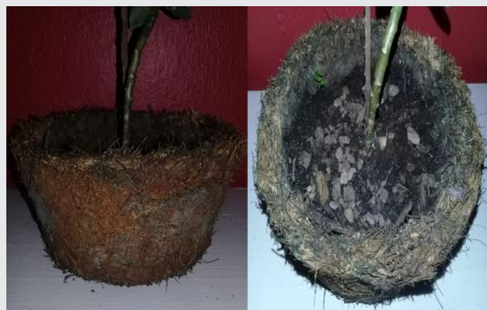
Figura 3. Degradación presentada durante las pruebas de resistencia a la humedad.
