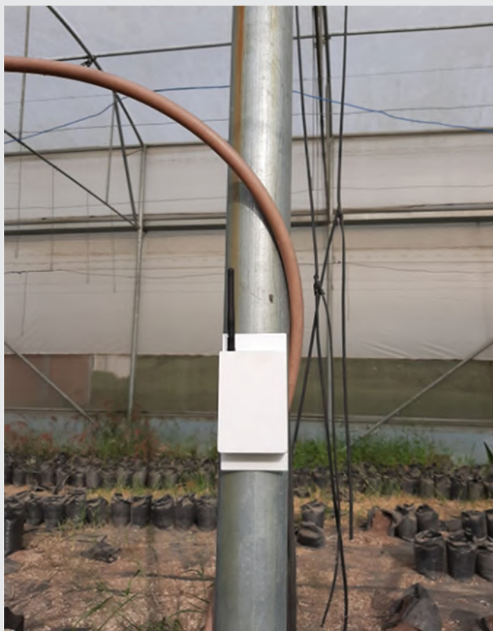
Figura 9. Sensor DHT22 dentro del invernadero.
