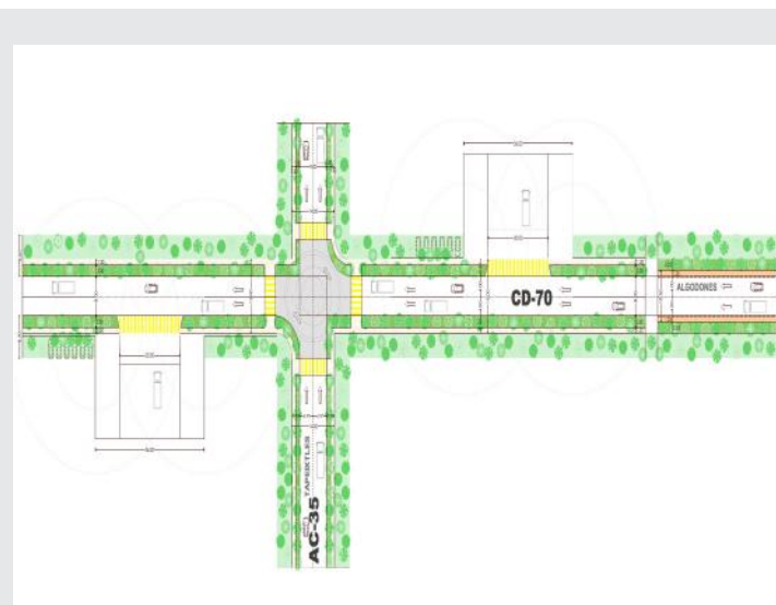
Figura 3. Esquema de circuitos para vialidades con corredores verdes en zonas con predominancia de usos industriales de la ciudad de Manzanillo
