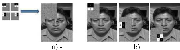
Figura 2. Aplicación de la imagen integral y convolución de filtros en el rostro.
