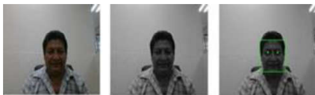
Figura 4.-Imagen original convertida a escala de grises y detección del rostro
